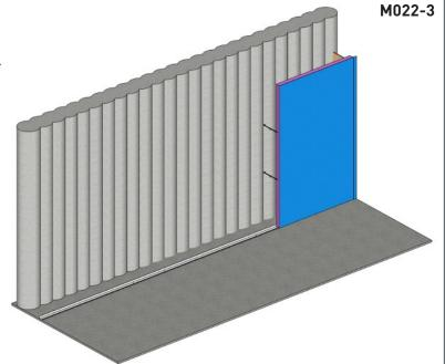
Der hintere Teil der Montagestange wird am Verbau fixiert. Der vordere Teil der Montagestange wird am thepro Element fixiert. Für den lotrechten Einbau wird die Montagestange mit dem Splintverschluss auf das erforderliche Maß genau angepasst.
