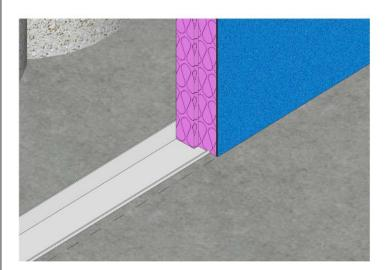
Die thepro Elemente werden von Innen an den Anschlagflügel des U-Profils angeschlagen.
