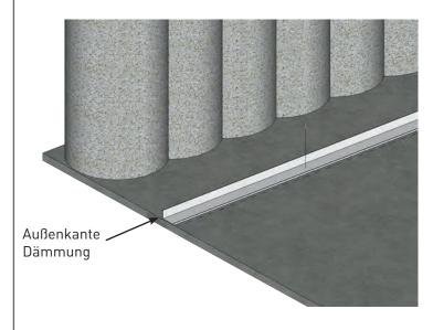
Das U-Profil muss eben auf der Sauberkeitsschicht fixiert werden (Fixierung nicht im Lieferumfang enthalten). Der hohe Anschlagflügel gibt die Außenkante der Dämmung vor.
